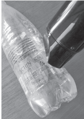
Figura 43. Remoção dos rótulos com o secador de cabelo
